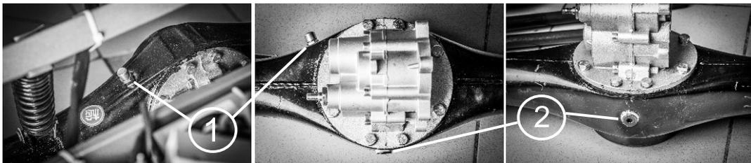
Открутите сперва заливную (1), потом сливную (2) пробки, так масло будет стекать лучше. Если сливная пробка оборудована магнитом для сбора металлических частиц, промойте ее прежде чем вкрутить на место. Для наилучшей герметичности используйте прокладочный герметик.
