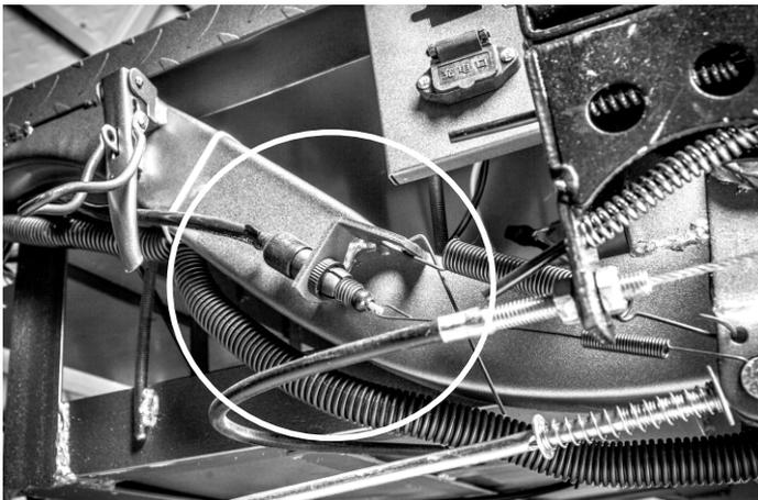
На трицикле установлен концевик включения стоп сигналов, он же отвечает за отключение электродвигателя. Концевик расположен на раме в нижней части правого борта трицикла.
