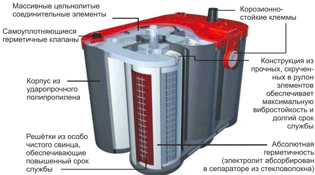
Гелевые аккумуляторы отличаются от большинства традиционных батарей тем, что они запечатаны, и электролит из них не выливается. В электролит добавлена двуокись кремния, которая сгущает гель внутри батареи. По этой причине гелевые аккумуляторы не протекают и более устойчивы к коррозии. В то же время гелевые аккумуляторы более дорогие, чем обычные батареи, и не возобновляются, что также означает, что их нельзя проверить гидрометром.
