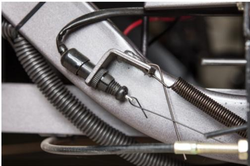
Внимание! Данный элемент отвечает за отключение мотора во время торможения!
