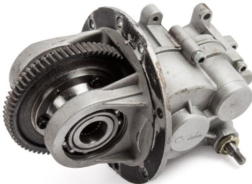
Задний мост служит опорой задней части трицикла. Посредством подвески, задний мост крепится к раме трицикла. Редуктор заднего моста состоит из нескольких узлов. Основными узлами являются главная передача, пониженная передача и дифференциал. Главной передачей является механизм, с помощью которого происходит повышение передаточного числа трансмиссии от электродвигателя трицикла.
