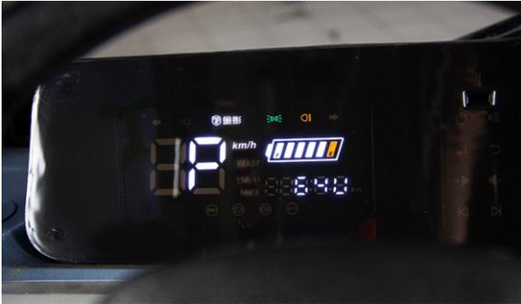
Ваш грузовой электрический трицикл оснащён приборной панелью, индикация которой содержит сведения о текущей скорости, общем пробеге, уровне заряда аккумуляторных батарей и другую информацию.
