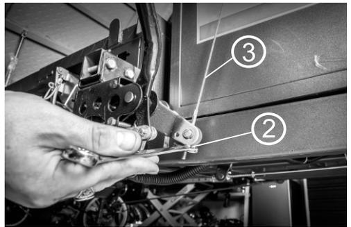
1. Поднять рычаг ручного тормоза (1) на 1-3 щелчка
