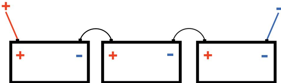
Во всех моделях электрических трициклов используют **последовательное** соединение аккумуляторных батарей.
