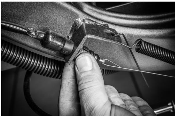
С помощью регулировочной гайки можно регулировать момент срабатывания включателя стоп-сигнала:
