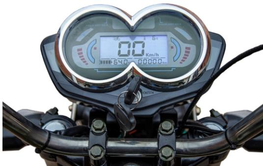
Ваш грузовой электрический трицикл оснащён приборной панелью, индикация которой содержит сведения о текущей скорости, общем пробеге, уровне заряда аккумуляторных батарей и другую информацию.
