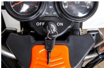
Выключатель зажигания имеет две позиции:
