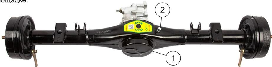
Для облегчения слива отработанной смазки из редуктора необходимо прогреть его путем поездки на ГЭТ в течении 10 - 15мин.
