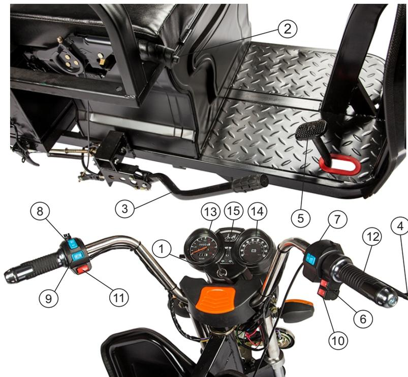
1. Замок и ключ зажигания
