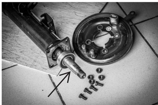
Задний мост – выражение понятное большинству автолюбителей. Для уточнения скажем: это единое целое, включающее в себя редуктор, полуоси и их корпус. Стрелкой на фото указана полуось, которая идёт от редуктора заднего моста и на которую надевается заднее колесо транспортного средства.
