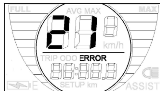
Пример индикации кода ошибки
