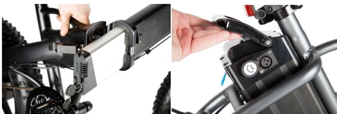
В этом нет ничего сложного. Как правило, аккумулятор фиксируется замком на раме. Необходимо повернуть ключ, разблокировать замок и снять аккумулятор.
