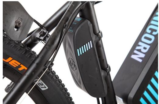
Берется аналогичный контроллер и при выключенном питании последовательно отсоединяются провода от старого контроллера и подключаются к новому.
